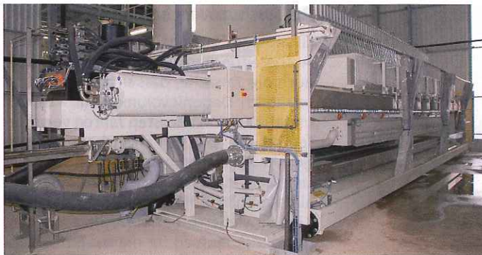
Die Kammerfilterpresse von Ammann ist neu mit einer automatischen Tücherwaschanlage ausgestattet.
