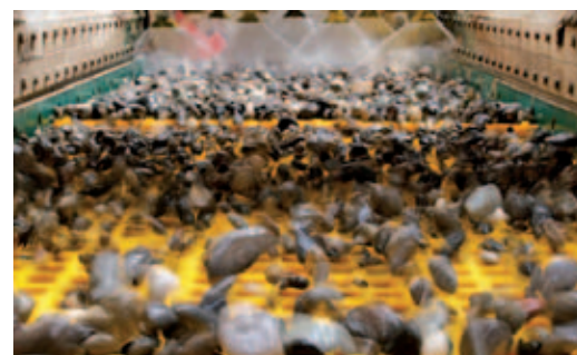
In mehreren Schritten wird der Aushub gebrochen und gewaschen.
